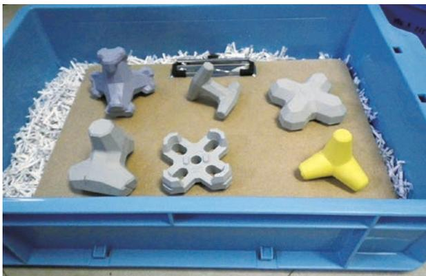
写真4 コンテナBOXと消波ブロックの模型
