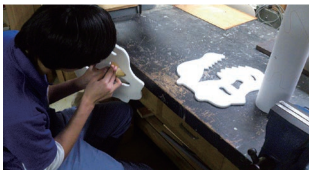
写真3 切り抜いたウレタンの断面を磨く
