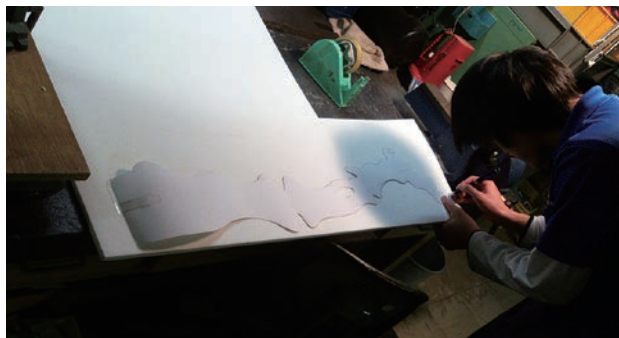
写真2 型紙を使いウレタンに骨の形を写しとる
